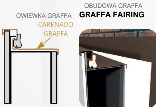
Monobloc internal structure Jednoczęściowa struktura wewnętrzna
