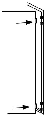
Türblatt in der Zarge positionieren, sowie obere und untere Türblattbandteile einhängen.
